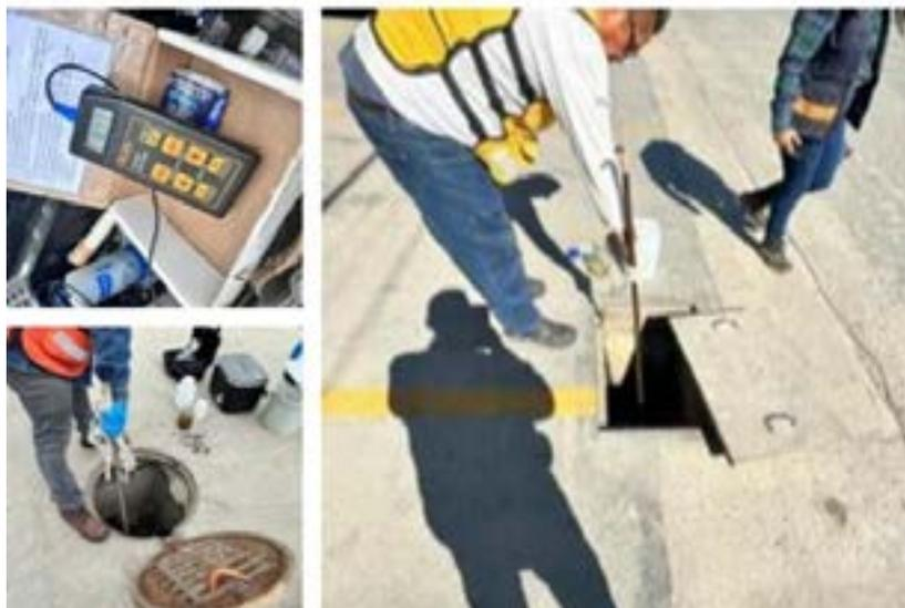
Nota: En la imagen se aprecia la toma de muestra realizada por un Laboratorio Acreditado ante la EMA con el objetivo de validar la calidad del agua residual en cumplimiento a la NTE- SLP-AR-01/005 del Estado de San Luis Potosí.
