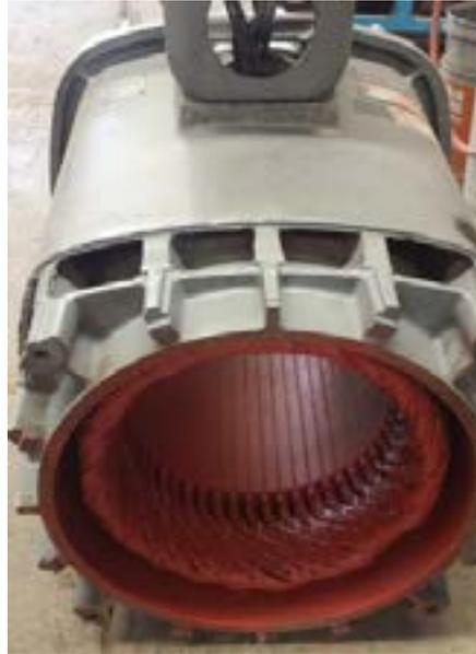
Estator y embobinado de motor ya reparado.
